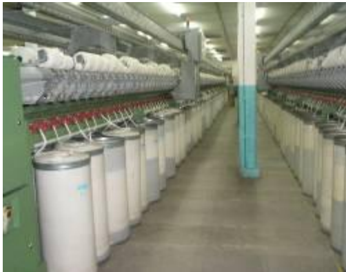
Figura 58: Fitas de algodão no filatório Fonte: Foto produzida pela autora em pesquisa realizada na Fabril Mascarenhas em 09/07/2009
