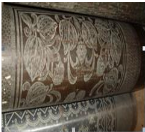
Figura 40: Cilindros para estampagem de lenços campesinos Fonte: fotos produzidas pela autora a partir de pesquisa realizada em 10/07/2009.
