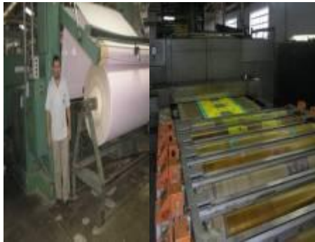
Figura 64: Tecido alvejado e cilindros para estampar controlados por computador Fonte: Foto produzida pela autora em pesquisa realizada na Fabril Mascarenhas em 09/07/2009
