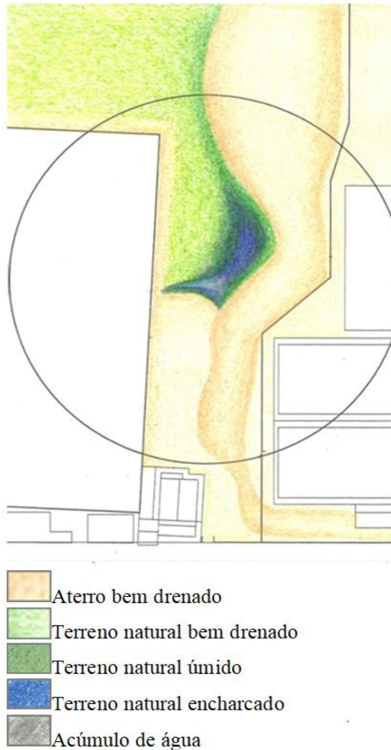
Figura 19 – Gradientes de umidade do solo no entorno da nascente
