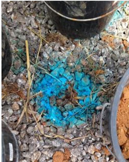
Figura 6 – Identificação da lixiviação de cobre ao final do experimento do tratamento controle (sem espécies vegetais).
